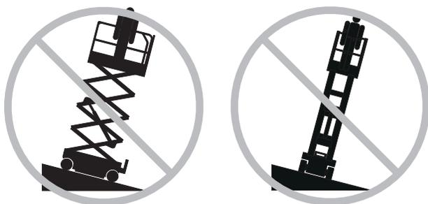
No confíe en la alarma de inclinación como indicador de nivelación. La alarma de inclinación instalada en el chasis sólo suena cuando la máquina se encuentra en una pendiente.
