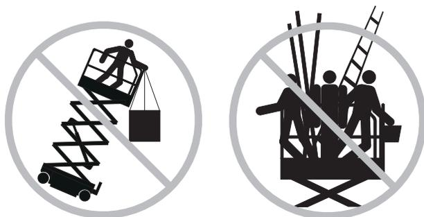
No coloque escaleras ni andamios en la plataforma ni los apoye en ninguna parte de la máquina.
