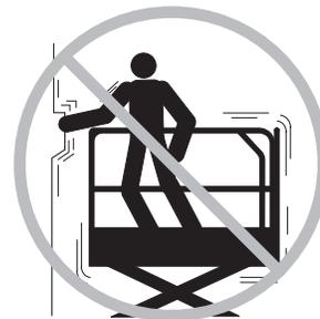
No modifique ni inutilice en modo alguno componentes de la máquina que podrían afectar a su seguridad o estabilidad.
